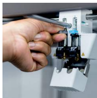
Print core CC 0,6 mm Punta di rubino per la stampa di materiali compositi abrasivi
